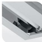
Lâmpada Fluorescente Tubular T5. Corpo em chapa de aço tratada e pintada. Painel em chapa de aço tratada e pintada. Refletor facetado em alumínio anodizado brilhante de alta refletância e alta pureza 99,85%. Soquete tipo push-in G-5 de engate rápido, rotor de segurança em policarbonato e contatos em bronze fosforoso. Instalação de embutir em gesso ou modulação 625x625mm ou 625x1250mm (perfis tipo T invertido).
